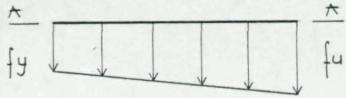
FIGURE 5 ALTERNATIVE DISTRIBUTION OF TENSILE STRESS ALONG PLANE A-A
