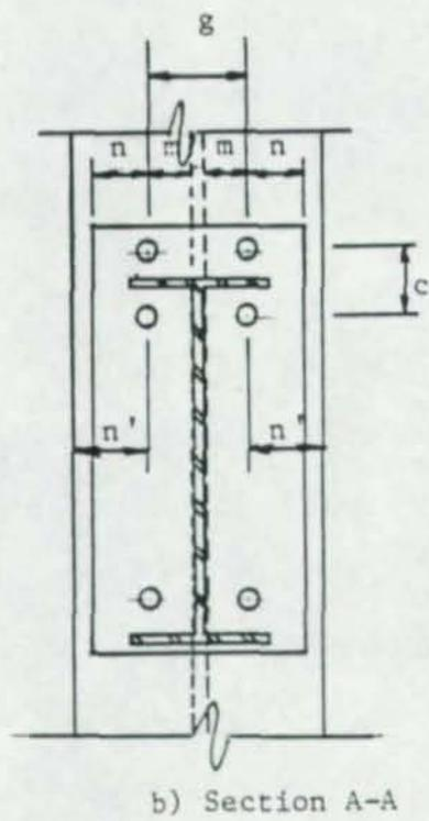
Figure 27. End-Plate Geometry
