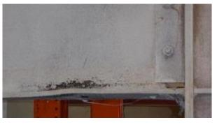
(d) Detail C (Beam Flange Local Buckling)
