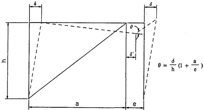
Fig. 4 TYPICAL ECCENTRIC BRACED FRAME
