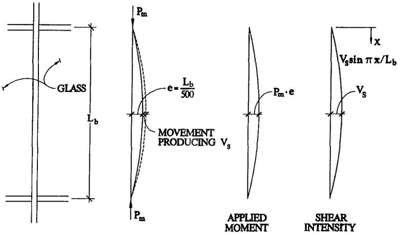
FIGURE 5 - BRACING OF OUT-OF-STRAIGHT MEMBER BY GLASS
