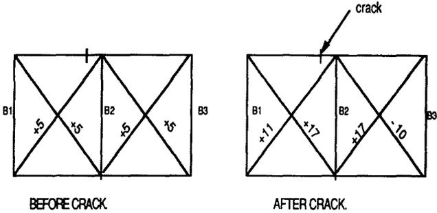
FIGURE 8. FORCES (KIPS) IN THE BRACING, AT THE VICINITY OF THE CRACK UNDER DEAD LOAD.
