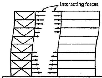
Fig. 8b DUAL SYSTEM LOAD INTERACTION
