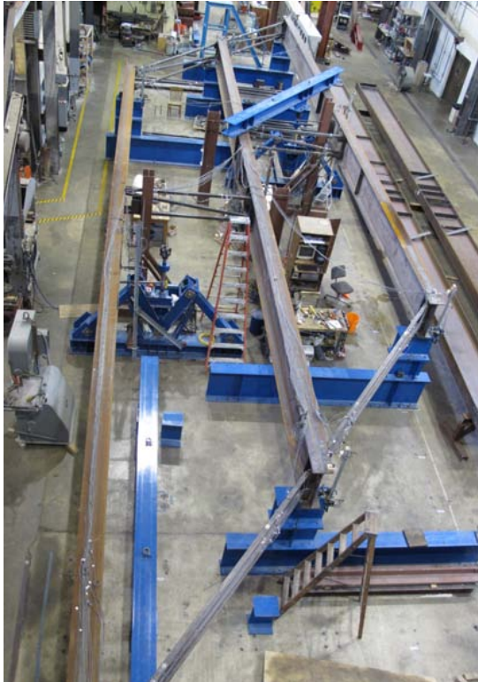
(d) Partial load on staggered cross frames
