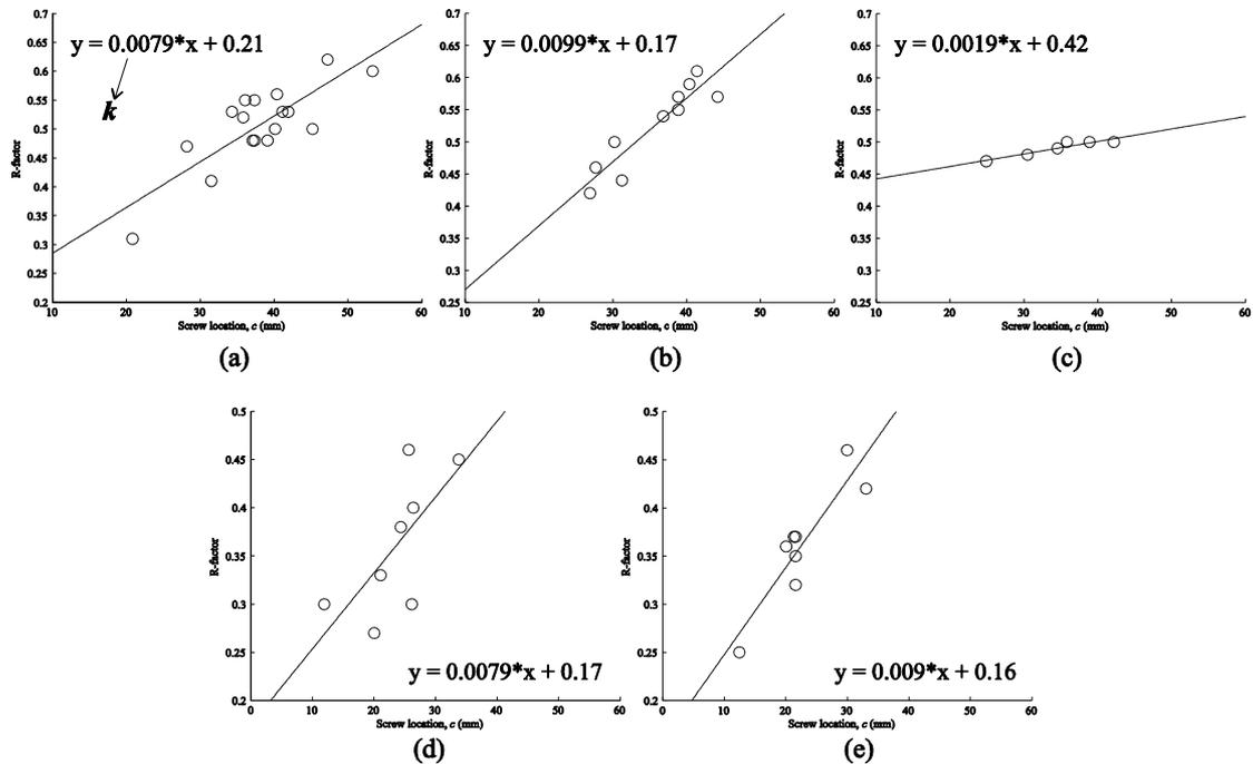
Figure 17: k-factors for (a) Z200 (b) Z250-A (c) Z250-B (d) C200 (e) C250
