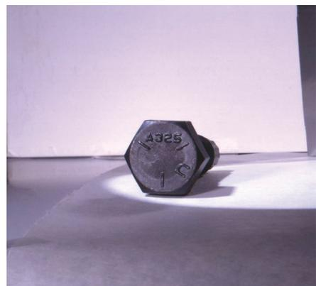
An ASTM A325 bolt.
